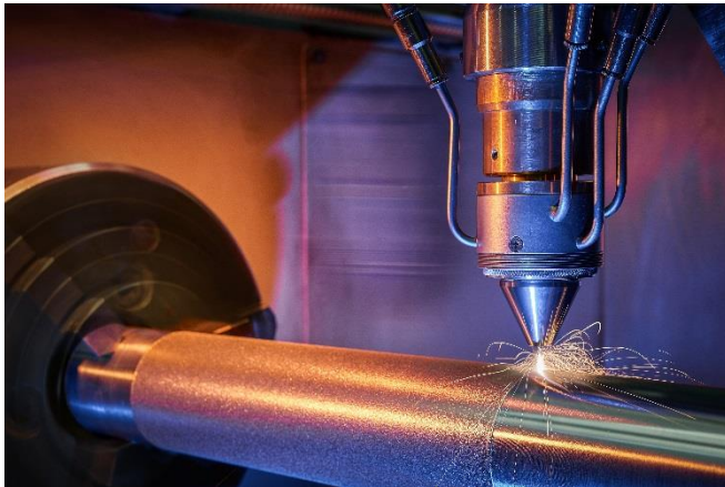
Bild 1: Mit EHLA lassen sich Metallschutzschichten mit extremer Hochgeschwindig- keit aufbringen. © Fraunhofer ILT, Aachen / Volker Lannert.
