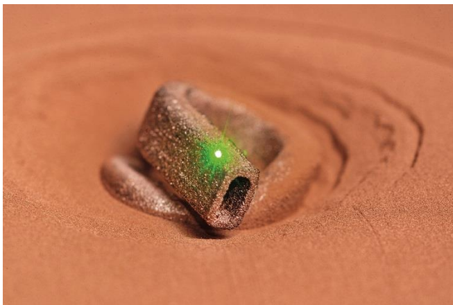
Bild 2: »SLM in grün«: Mit dem neuen Prozess sollen sich auch Bauteile aus reinem Kupfer additiv fertigen lassen. © Fraunhofer ILT, Aachen.
