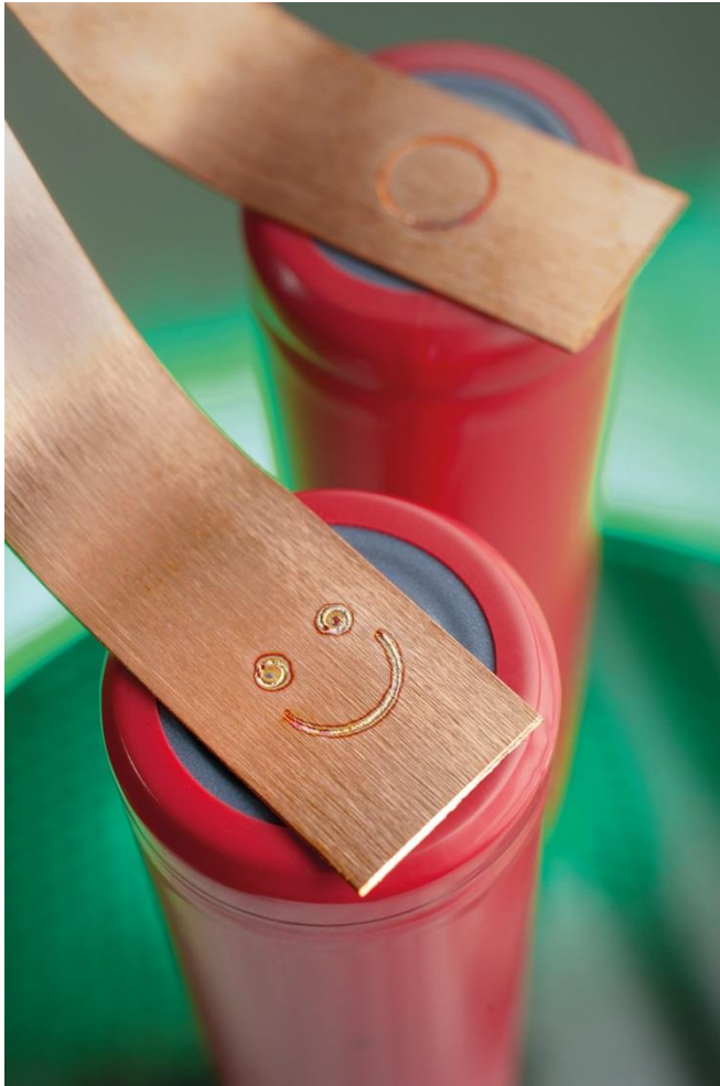
Bild 3: Plus für Kollaboration: Auf der productronica demonstriert das Fraunhofer ILT, wie sich das Laser-Based Tape-Automated Bonding (LaserTAB) beim Schweißen von Batteriezellen optimieren lässt. © Fraunhofer ILT, Aachen.
