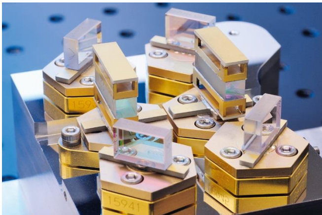
Bild 3: Mit neuen Löttechniken konstruiert: Ein optisch parametrischer Oszillator (OPO) für das MERLIN-LIDAR-System. © Fraunhofer ILT, Aachen.
