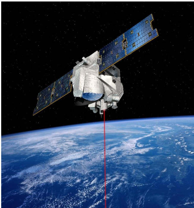
Bild 1: Künstlerische Darstellung des MERLIN-Instruments auf Basis der Myriade- Satellitenplattform. © CNES/illustration David DUCROS, 2016.
